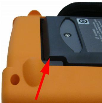
**Figura 8-1** Spingere nel senso indicato dalla freccia per rimuovere il supporto
