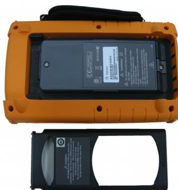
**Figura 8-2** Disassemblare il supporto dallo strumento
