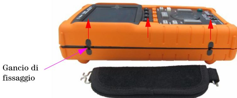
**Figura 8-8** Rimuovere la maniglia dallo strumento
