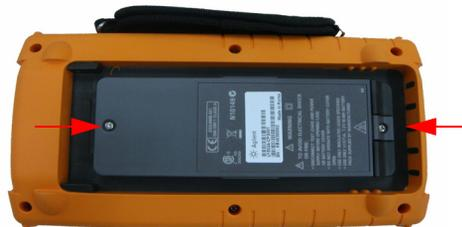
**Figura 8-3** Rimuovere le viti del coperchio della batteria
