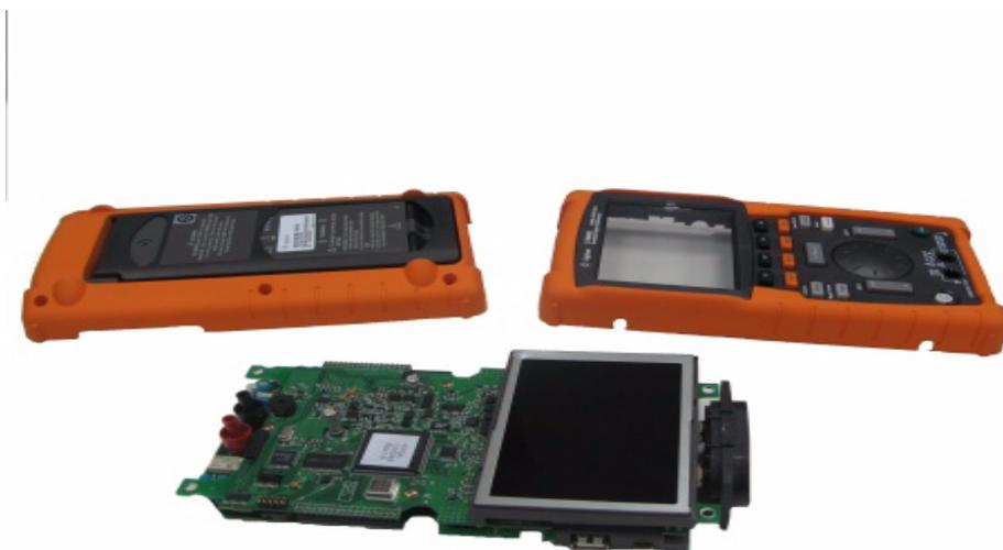
**Figura 8-10** Rimuovere la custodia anteriore (destra) e posteriore (sinistra) dalla scheda PCBA dello strumento
